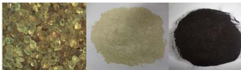
Areia base (Sílica) Bentonita (Argila) Pó de carvão mineral Figura 2: Matérias primas da Areia de Moldagem.
